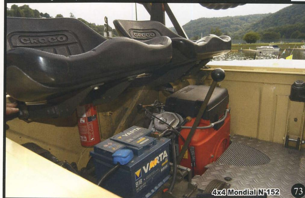
avec comme conséquence, une capacité de franchissement extraordinaire d'autant plus que ses 4 roues sont à la fois motrices et directrices. Bon d'accord, le Croco ne dispose pas de suspension et sur chemin, le confort n'est pas franchement mauvais comme on pourrait s'y attendre car les occupants bénéficient de la mollesse des roues basse pression et des sièges bien suspendus dotés de ressorts en caoutchouc.
