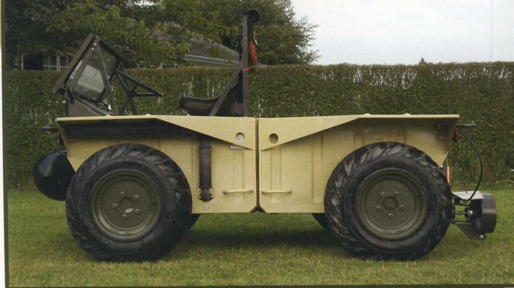
■ En cas de pluie, on peut déplier la bâche fixée sur l'arceau et l'attacher sur le demi pare-brise supérieur alors déployé. Les deux caissons identiques et symétriques sont équipés de roues en aluminium et de pneus de la marque.
