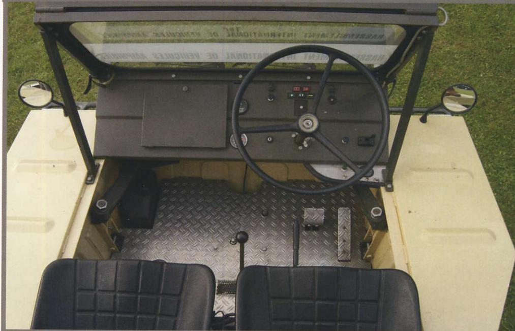
■ Sous les sièges avant, prennent place le moteur, la batterie et le réservoir, en fait un simple jerrycan de 20 litres.
