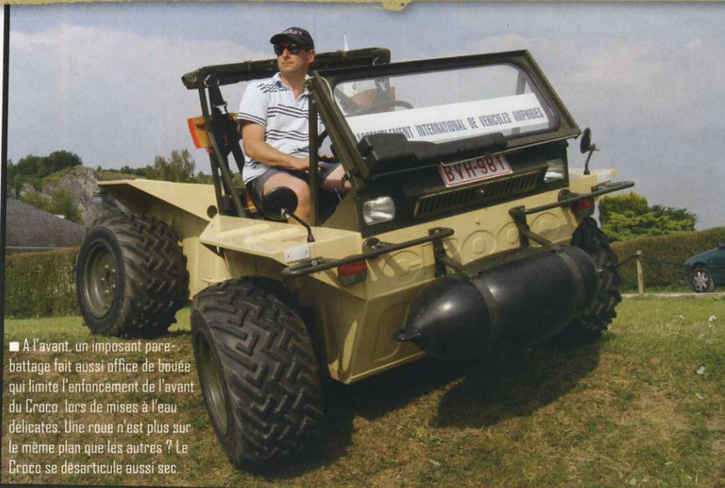
■ A l'avant, un imposant pare-battage fait aussi office de bouée qui limite l'enfoncement de l'avant du Croco lors de mises à l'eau délicates. Une roue n'est plus sur le même plan que les autres ? Le Croco se désarticule aussi sec.
